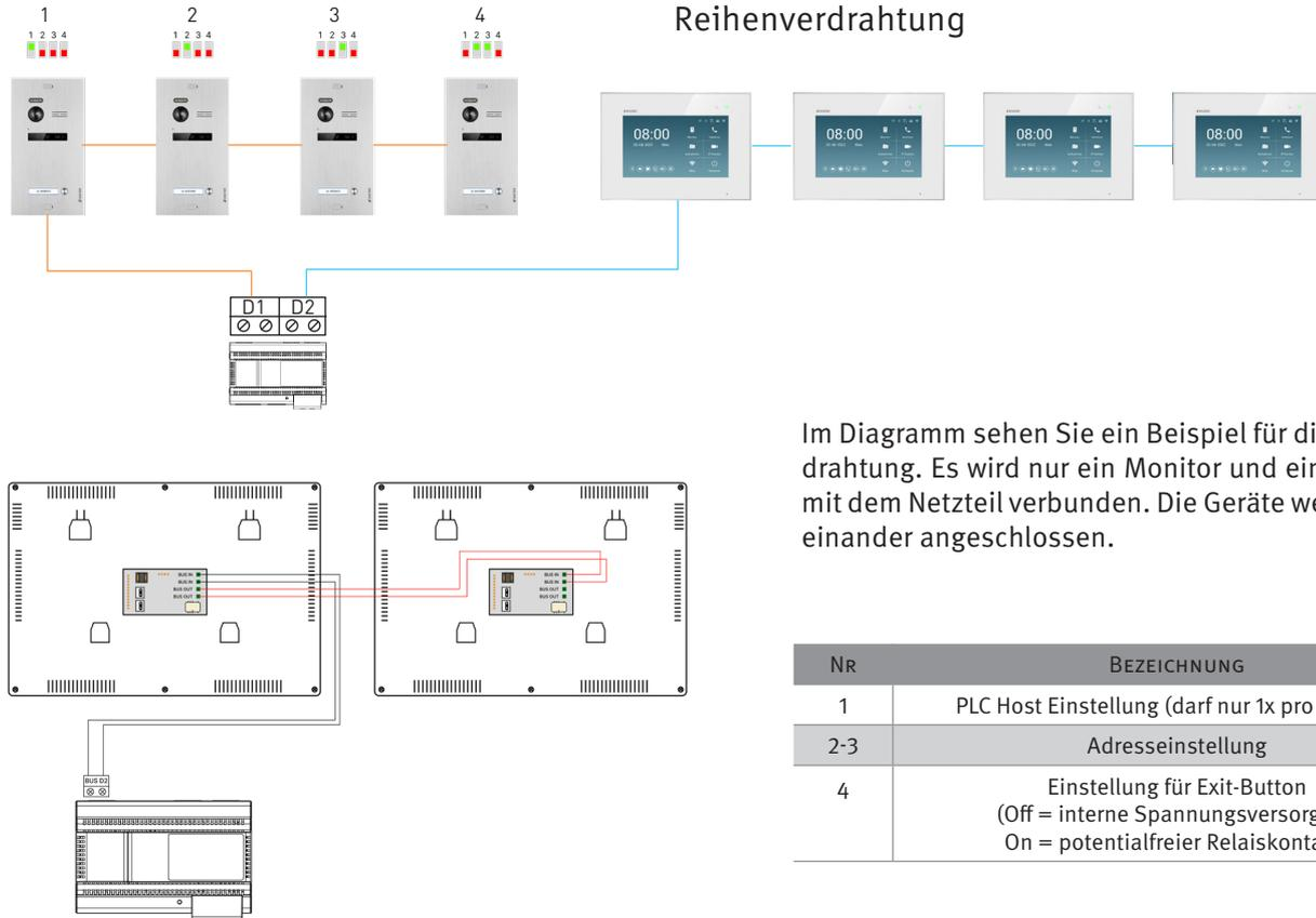
Im Diagramm sehen Sie ein Beispiel für die Reihenverdrahtung. Es wird nur ein Monitor und eine Türstation mit dem Netzteil verbunden. Die Geräte werden alle an einander angeschlossen.
