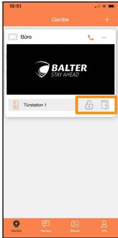
Tippen Sie unten rechts, bei der gewünschten Türstation, auf das Schlosssymbol, um den Türöffner von der internen Spannungsversorgung zu öffnen, oder das Türsymbol, um den Türöffner von dem potentialfreien Relaiskontakt zu öffnen.
